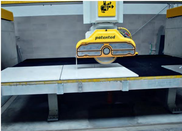
Die neue CNC-Maschine zur maßgerechten Herstellung von Platten
