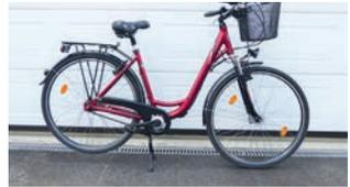
**Damenfahrrad** (Deutsches Markenfabrikat), Hersteller: Kwasny & Diekhöner, Herforder Straße 331, Bielefeld; Rahmen: Aluminium RH 50, Shimano 7-Gang Drehgriff-Nabenschaltung, Felgenbremse vorn und hinten, zusätzl. Rücktritt, gefederte Sattelstütze und gefederte Vordergabel einstellbar, Bestzustand, Abgabepreis 195 € cash, ☎ 0152-29563766 (ganztags erreichbar).
